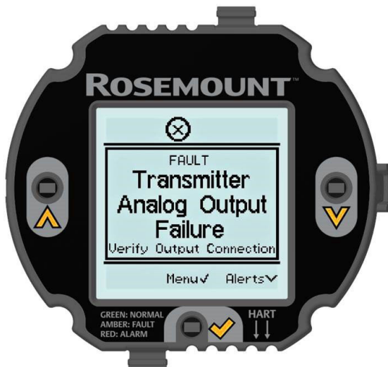
Рисунок 2-12. Экран неисправности в токовом контуре
