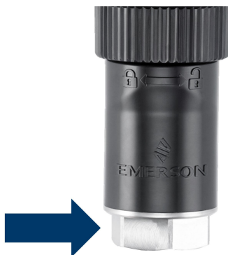
Рисунок 4-2. Идентификатор лысок под ключ в нижней части корпуса 781S
