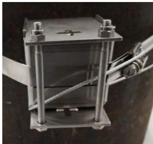
5. Проденьте оголенный конец через отверстие для ленты каждого датчика, отверстие для троса в головке датчика и через возвратное отверстие тросового замка.
