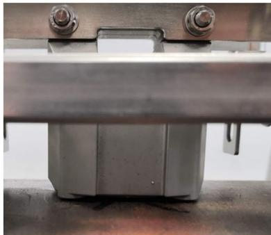
8. Установите 4 крепежных болта датчика, стопорные шайбы и гайки магнитного крепежного приспособления, как показано на [Рисунок 4-11](#).
