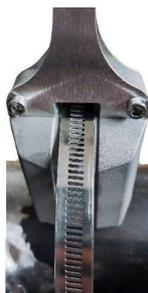
7. Если запасная лента имеет чрезмерную длину, излишки можно отрезать. Поместите ленту на червячный механизм натяжителя и обрежьте ее сразу после головки винта.
