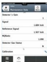
Рисунок 2-4. Экраны, отображаемые при калибровке нуля с помощью программного обеспечения WinHost®
