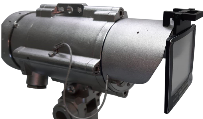
Рисунок 2-6. Детектор с установленным фильтром проверки
