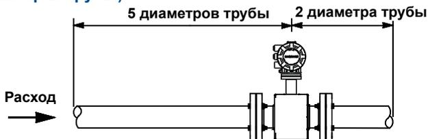
Возможна установка с меньшими длинами прямых участков трубопровода перед и после расходомера. При меньших длинах прямых участков до и после расходомера прибор может не обеспечивать абсолютных значений точности, указанных в технических характеристиках. Воспроизводимость результатов измерения расхода будет по-прежнему высока.
