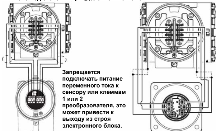
Рисунок 17. Схема подключения при удаленном монтаже
