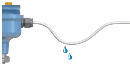
8. Установите заглушку и загерметизируйте неиспользуемый кабельный канал для предотвращения скопления влаги и пыли внутри корпуса.
