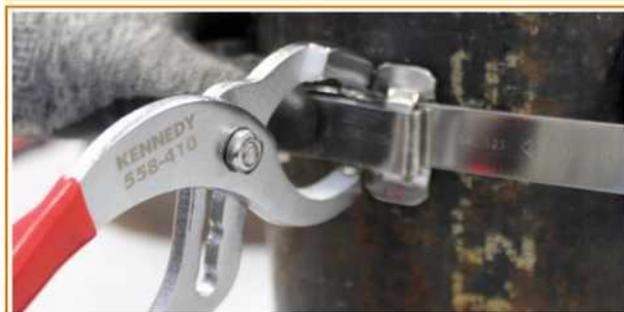
16. Обрежьте свободный конец стропы примерно на 2 см, затем поверните конец внутрь плоскогубцами, чтобы скрыть острый край стропы.
