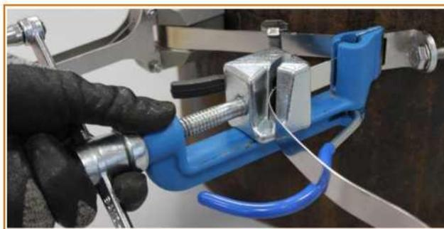
11. Сдвиньте натяжитель по направлению к датчику, прижав его к трубе. Освободите стропу, используя черную ручку на инструменте, при этом удерживая стропу в направлении трубы.
