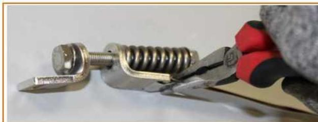
8. Пока один человек держит датчик в желаемом месте, другой должен обернуть свободный конец стропы вокруг трубы и через прорезь для стропы в датчике. Проденьте конец стропы через пряжку так, чтобы «ушки» пряжки были обращены к натяжителю стропы, а затем через другую прорезь в натяжителе.
