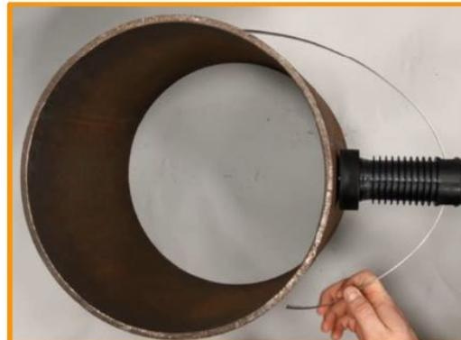
8. Затем пропустите строп в один из торцов натяжителя стропа и, используя плоскую отвертку или ключ с головкой, поворачивайте винт натяжителя, пока конец стропа не появится из-под червячного механизма (потребуется не менее 5 оборотов винта).
