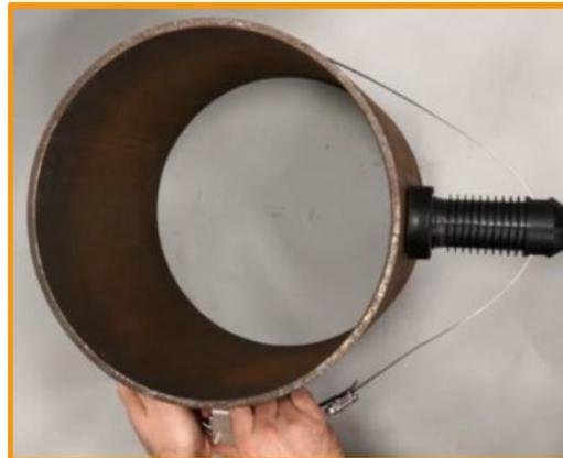
9. Разместите натяжитель стропа таким образом, чтобы строп только касался трубы на участке между датчиком и натяжителем стропа, как показано ниже.
