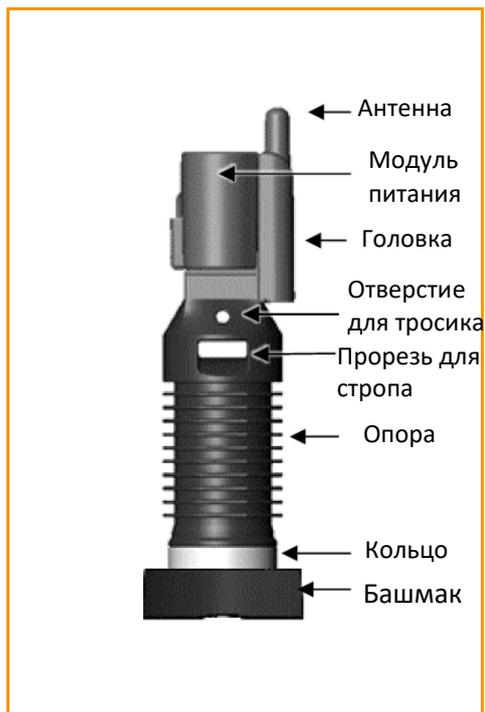
После установки датчик обменивается данными со шлюзом, заданным при установке, а также с другими, ранее установленными датчиками, которые приписаны к этому же шлюзу. Эти датчики образуют беспроводную ячеистую сеть. Управление ячеистой сетью осуществляется с помощью шлюза, который выбирает оптимальный путь передачи данных от датчика шлюзу. Затем шлюз отправляет эти данные в базу данных. Конечный пользователь может просмотреть данные от всех датчиков через интерфейс ПО Data Manager.
