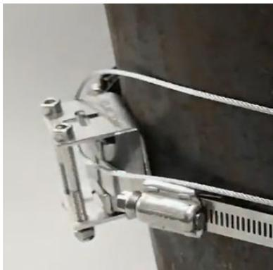
5. Пропустите оголенный конец троса через отверстие для троса каждого сенсора, а затем через возвратное отверстие тросового замка.
