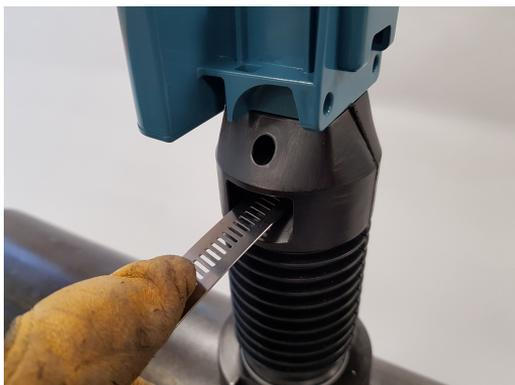
7. Если запасная лента имеет чрезмерную длину, излишки можно отрезать. Поместите ленту на червячный механизм натяжителя и обрежьте ее сразу после головки винта.
