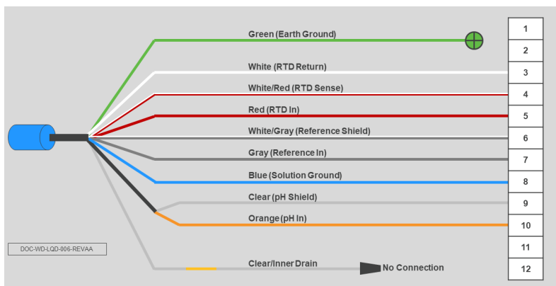
Рисунок 3-6. Датчик рН/ОВП Rosemount 396Р, 396РVP, 396РVP, 3300НТVP, 3400 НТVP, 3500Р, 3500VP, 3900 или 3900VP без предусилителя для подключения измерительного преобразователя Rosemount 5081
