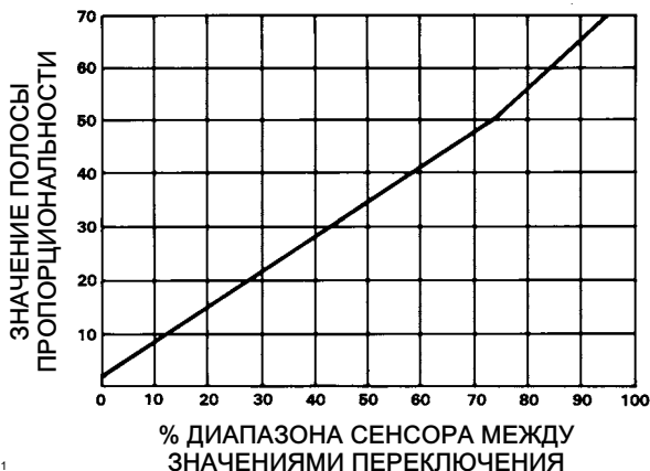
Рис. 5-3. Кривая для определения значения полосы пропорциональности
