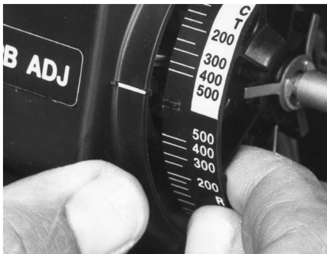
Рис. 4-2. Изменение действия контроллеров Fisher 4195KB и KC
