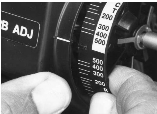
Рис. 3-2. Изменение действия контроллера (контроллеры Fisher 4195KA)
