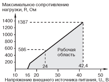
Рис. 15. Диаграмма сопротивлений для уровнемера в безопасной зоне.
