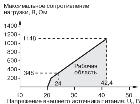
Рис. 17. Диаграмма сопротивлений для уровнемера, сертифицированного на взрывобезопасность.
