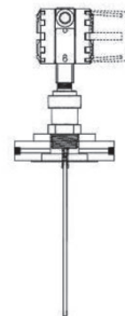
Рис. 6. Rosemount серий 3300/5300 с промывочным/продувочным соединением.
