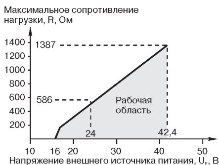
Рис.24. Диаграмма сопротивлений для уровнемера в безопасной зоне.
