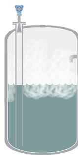
Измерение турбулентных сред с низкой диэлектрической проницаемостью в успокоительных колодцах, в том числе при наличии внутренних конструктивных препятствий.
