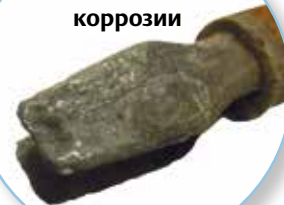
Вилка со следами коррозии
