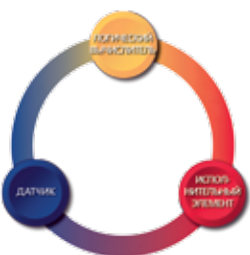
Система аварийного останова
