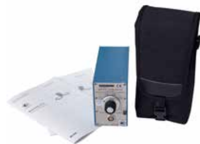
Устройство для проведения имитационной поверки расходомеров - имитатор 8714.
