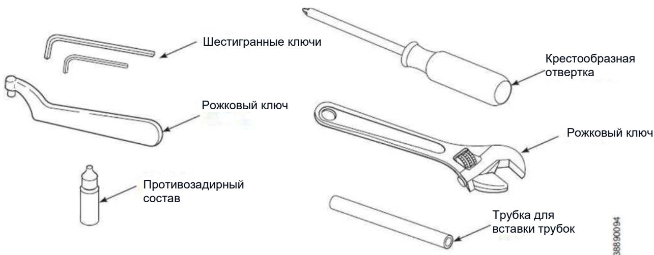
Рис. 10-2. Комплект для разборки зонда
