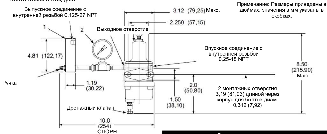
Рис. 3-11. Блок подачи воздуха, подключение к системе технического воздуха
